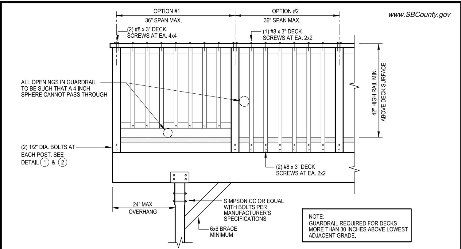
(A) TYPICAL RAIL ELEVATION
